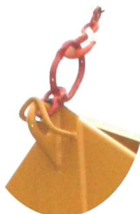
Détail du système de détrompeur
