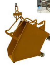
Repose de la benne et passage de palonnier en position avant
