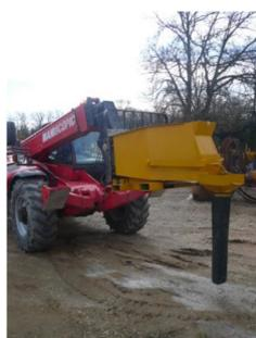
Benne BSB équipée d'un tuyau longueur 1m reprise au chariot élévateur.
