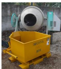
Benne BSB sous bétonnière
