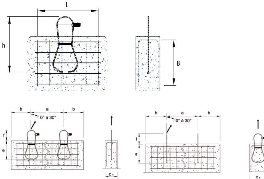
L'angle de tirage par rapport à l'axe de la boucle de levage devra être inférieur à 30 degrés et rester dans le plan longitudinal de l'élément.
