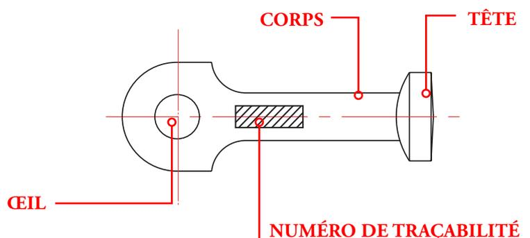
L'ANCRE À ŒIL NE PEUT EN AUCUN CAS ÊTRE UTILISÉE SANS SON ARMATURE DE RENFORT (ACIER HAUTE ADHÉRENCE, SELON NORME NF A35-80). L'ARMATURE DE RENFORT DOIT SE POSITIONNER OBLIGATOIREMENT DANS L'ŒIL DE L'ANCRE PRÉVUE À CET EFFET. RESPECTER LA MISE EN ŒUVRE ET L'UTILISATION DE NOS ANCRÉS EN FONCTION DES RÈGLES DU BAEL 91 ET NORMES EN VIGUEUR SUR LE SYSTÈME DE LEVAGE.
