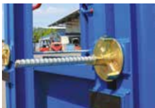
Utilisation de l'outil avec tiges de Ø17 ou 23mm
